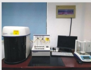
比表面积及孔隙度分析仪 Micromeritics Gemini VII 2390 Surface Area Analyzer
