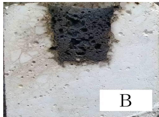
立拓 LITAL™-MSC 作为骨料对铝镁浇注料性能影响实验
